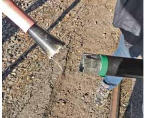
Leider ermüdet nach einigen Jahren das Boots- material: Beim Start brach dieser Innenhebel.
